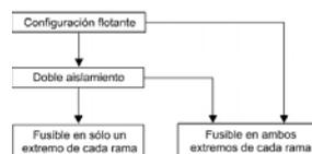
Fig. 18. Requisitos para la localización de fusibles.
