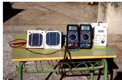
Fig. 3. Ensayo de cortocircuito de dos células FV en serie.
