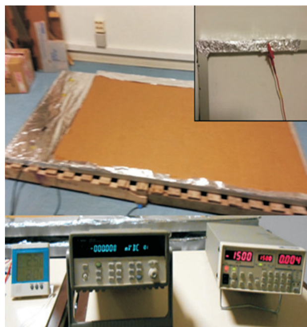
Figura 8.- Montaje ensayo PID.
