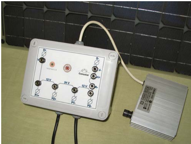
Fig. 5.11. Vista exterior de los cables de los módulos fotovoltaicos y del cable de entrada del inversor conducidos hacia el interior de la caja de conexión y medida a través de sus pasacables correspondientes.
