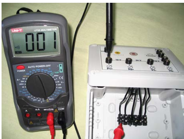
Fig. 5.5. Izquierda: proceso de identificación de uno de los terminales de la regleta con ayuda del multímetro. Obsérvase el símbolo de señal acústica en la parte inferior izquierda de la pantalla del multímetro indicando contacto eléctrico entre el borne exterior de la tapa y el terminal de la regleta. Derecha: identificación y marcado completo de los terminales de la regleta interior de la caja.
