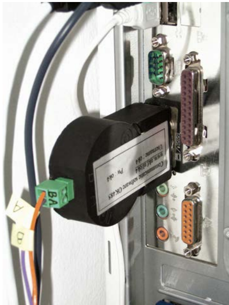
Fig. 5.19. Vista en detalle de la conexión del módulo de comunicaciones OK485 a un puerto serie del ordenador, en este caso el COM2. Si el ordenador no dispone de puerto serie, puede probarse con un adaptador-conversor USB-serie.
