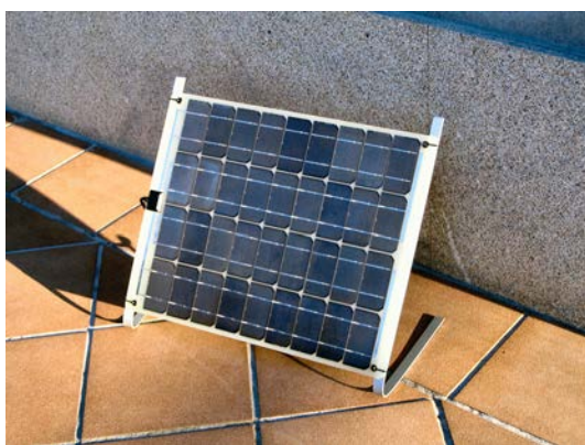
Fig. 5.26. Otra posibilidad consiste en emplear perfiles metálicos planos normalizados, habitualmente disponibles en tiendas especializadas y grandes superficies comerciales, para formar una sencilla estructura soporte cuya fijación se puede llevar a cabo utilizando métodos convencionales. Obsérvese nuevamente la utilización de las bridas de plástico para sujetar, en este caso, los perfiles metálicos al módulo.
