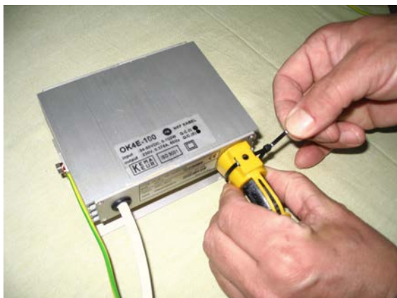
Fig. 5.16. Conexión entre el inversor y su cable de salida. Los conectores de cuatro polos sólo admiten una posición para su conexión, lo cual evita cualquier posible confusión (imagen superior). Una vez insertado el cable a fondo, la conexión se debe asegurar colocando la abrazadera tal como se muestra en la imagen del centro. Para finalizar, se pasa la brida plástica que se incluye con el kit por la ranura de la abrazadera y se procede a apretarla convenientemente (imagen inferior).
