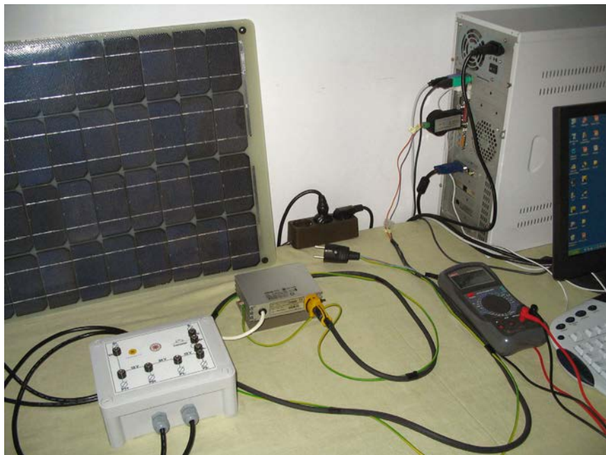
Fig. 5.18. Vista general de los elementos del kit PVSun convenientemente interconectados. Obsérvese la conexión del módulo de comunicaciones OK485 al ordenador, cuyo detalle se muestra en la figura 5.19.
