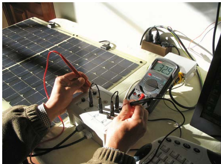
Fig. 5.28. Cuando el inversor está entregando corriente a la red, la tensión en bornes del generador fotovoltaico es inferior a la de circuito abierto y próxima al valor correspondiente al punto de máxima potencia, como corresponde al funcionamiento interno del inversor.
