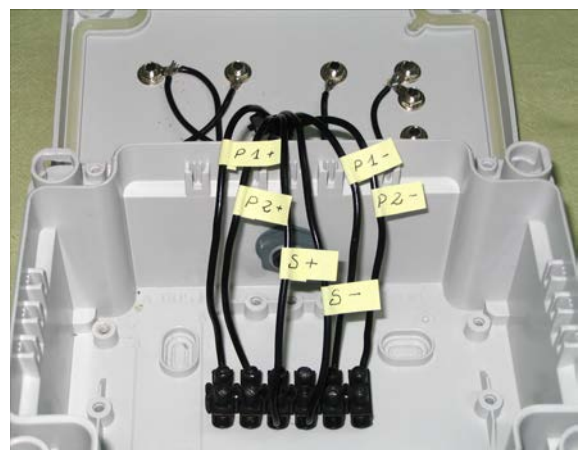
Fig. 5.5. Izquierda: proceso de identificación de uno de los terminales de la regleta con ayuda del multímetro. Obsérvase el símbolo de señal acústica en la parte inferior izquierda de la pantalla del multímetro indicando contacto eléctrico entre el borne exterior de la tapa y el terminal de la regleta. Derecha: identificación y marcado completo de los terminales de la regleta interior de la caja.
