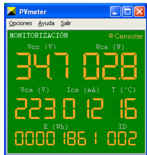
Fig. 6.11. Ejemplo de configuración personalizada de la apariencia de la interfaz gráfica del programa, en la que se ha elegido el color naranja para los displays numéricos y el gráfico de potencia, y la visualización reducida que abarca sólo el panel de los displays numéricos.
