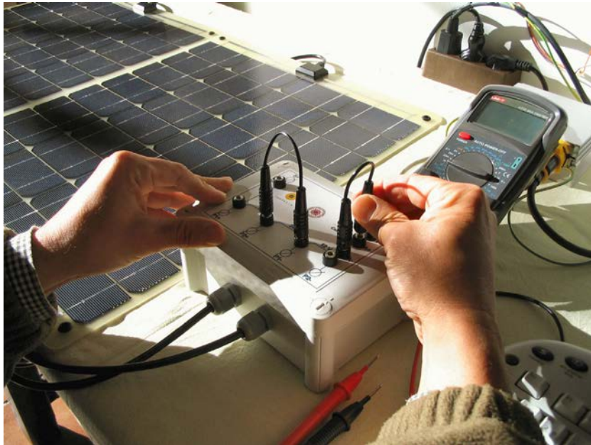
Fig. 5.29. Modo correcto de retirar un puente de conexión, agarrándolo por la funda plástica del conector metálico.
