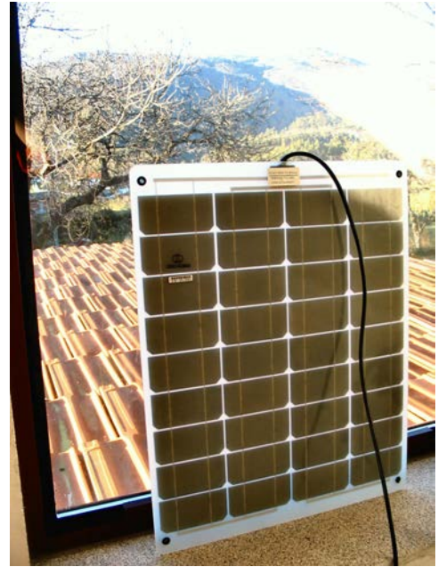
Fig. 5.22. Una de las formas más sencillas de colocar el módulo consiste en apoyarlo directamente sobre la parte interior de una superficie acristalada. De esta manera, el módulo queda muy accesible y se facilita su manipulación.
