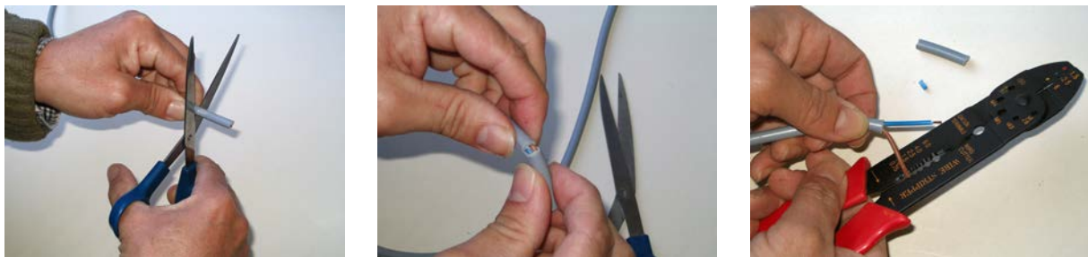
Fig. 5.6. En la operación de pelado de un cable se debe prestar especial atención a no deteriorar la funda protectora de los cables interiores ni sus hilos conductores. Siempre es recomendable utilizar herramientas adecuadas (profesionales), como los alicates de la derecha, antes que otras de uso convencional, como las tijeras. En este último caso se requiere más práctica y cuidado para efectuar la operación correctamente.
