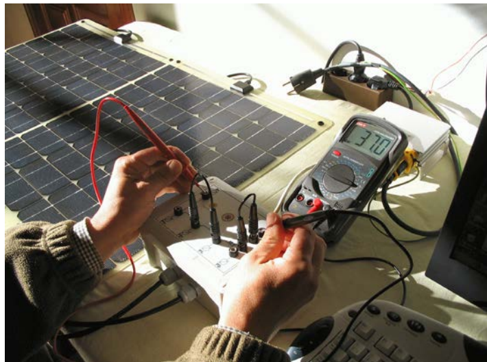
Fig. 5.27. Medición de la tensión a circuito abierto del generador fotovoltaico.
