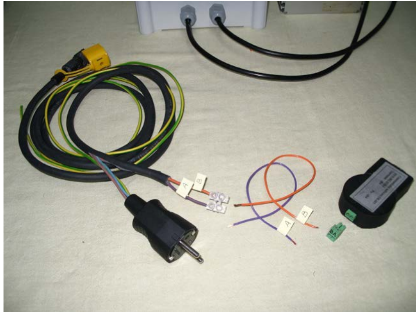
Fig. 5.2. Vista del cable de salida del inversor y del módulo de comunicaciones OK485. Obsérvense los cables azul y marrón para conexión a la red, conectados ya a la clavija junto con el cable de puesta a tierra, y los cables violeta y naranja, convenientemente marcados, para conexión al módulo de comunicaciones. Obsérvese también el marcado del terminal extraíble de este módulo.
