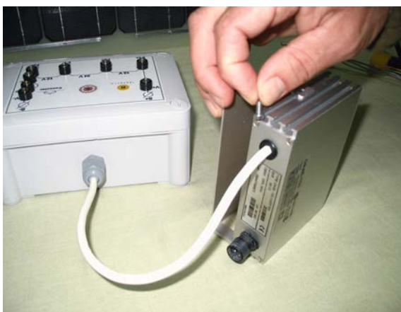
Fig. 5.14. Acoplamiento entre el inversor y la placa de sujeción. La placa de sujeción dispone de dos terminaciones (a modo de gancho) que se pueden introducir en cualquiera de las tres ranuras laterales del inversor (imagen superior izquierda). Hecho lo anterior, la placa puede pivotar sobre estos ganchos, permitiendo que el orificio abierto para el tornillo se pueda situar en las ranuras del lado opuesto del inversor (imagen superior derecha). Colocada ya la placa en su posición final, el tornillo se pasa por la ranura correspondiente del inversor con su lado roscado hacia fuera, permitiendo así la colocación de una tuerca que mantendrá unidos el inversor y la placa (imagen inferior izquierda).
