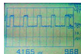
Figura 4. Comprobación del estado de funcionamiento de un regulador tipo paralelo. En este caso, las sondas del polímetro se han colocado en los terminales correspondientes al campo FV para comprobar el estado del transistor de control de carga.
