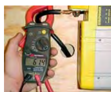
Figura 6. Utilización de una pinza amperimétrica para medir la corriente en el circuito baterías-inversor. En este caso, la pinza se ha colocado en el conductor negativo de entrada del inversor.
