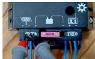
Figura 4. Comprobación del estado de funcionamiento de un regulador tipo paralelo. En este caso, las sondas del polímetro se han colocado en los terminales correspondientes al campo FV para comprobar el estado del transistor de control de carga.
